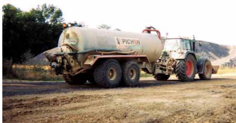
Arrosage des pistes (LGV Est Européenne) (Source : Equipement et Environnement, 2003)
